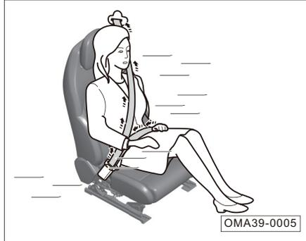
El pretensor y limitador de fuerza del cinturón de seguridad puede reducir la presión del cinturón de seguridad en el pecho del conductor, y mejorar el rendimiento de protección.
