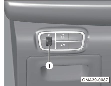
Gire la perilla
