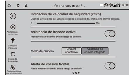
El conductor puede seleccionar “Asistencia de cruceo integrado” en la función “Configuración del vehículo” → “Asistencia de conducción” → “Modo cruceo” del sistema de audio.
