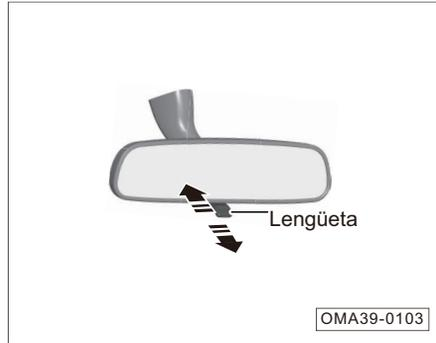
El ajuste manual del espejo retrovisor interior antideslumbrante manual puede reducir el reflejo de la parte trasera, y hacer que la visión trasera esté en el mejor estado de observación.
