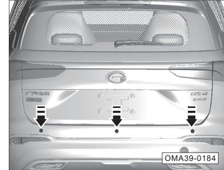
El sensor de radar queda instalado en la cubierta del parachoques trasero.
