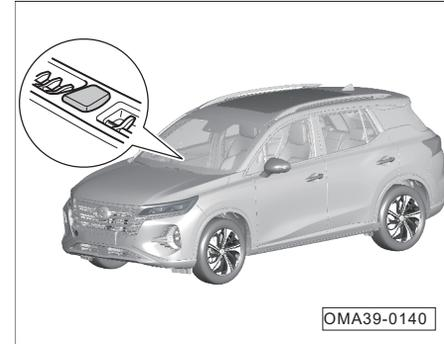
En el modo automático, el sistema de control del aire acondicionado puede detectar la temperatura y la luz solar dentro y fuera del vehículo a través del sensor de luz solar. Tenga cuidado de no cubrir el sensor de luz solar.
