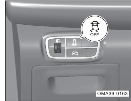
El sistema ESP está activado de forma predeterminada al conducir el vehículo.
