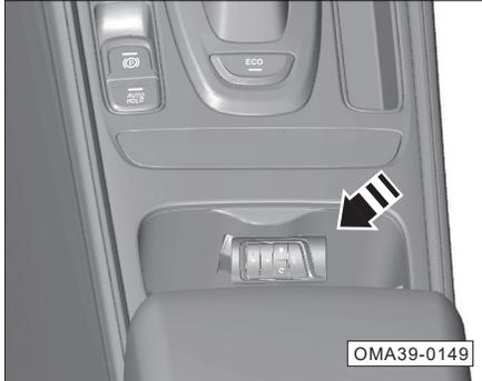
Si la batería de la llave de control a distancia se encuentra agotada y el medidor de combinación muestra "No se detectó ninguna llave", puede colocar la llave inteligente horizontalmente en la marca de la llave en la parte inferior del portavasos delantero y luego presionar el interruptor de inicio para cambiar a "ACC" o "ON", vuelva a pisar el pedal del freno, la luz indicadora del interruptor de encendido iluminará color verde, presione el interruptor nuevamente para arrancar.
