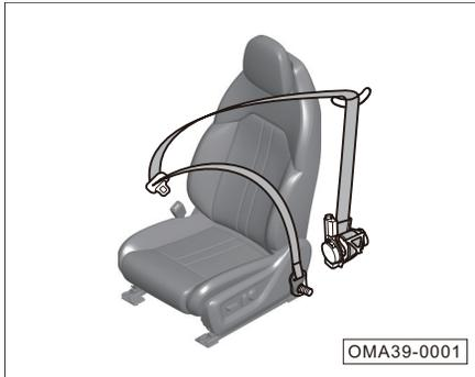
En caso de colisión del vehículo, el cinturón de seguridad ayuda a otros sistemas de seguridad del vehículo a absorber al mismo tiempo, la energía generada por la colisión, reduciendo aún más las posibles lesiones al conductor y pasajeros.
