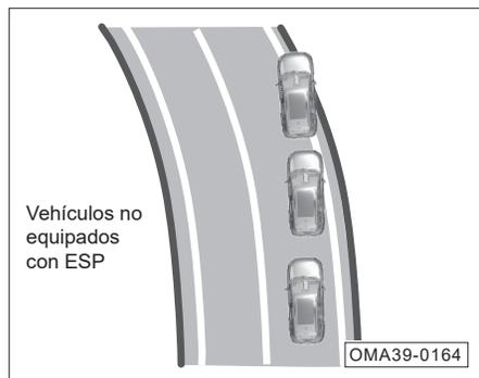
Cuando los vehículos sin equipar el ESP se deslizan y se desvían de la ruta de conducción normal.
