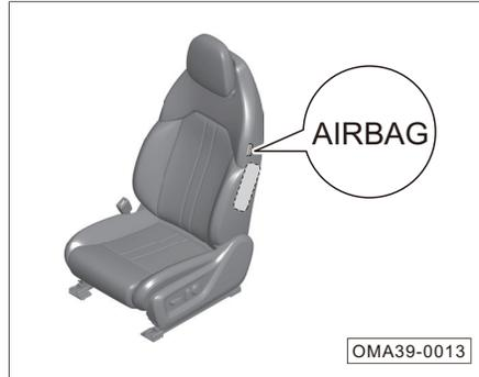
El airbag lateral de la fila delantera está montado en el interior de la respaldo del asiento del conductor y asiento del pasajero, que está en el lado hacia la puerta (parte sombreado por línea de puntos), y "SRSAIRBAG" es el símbolo del airbag.
