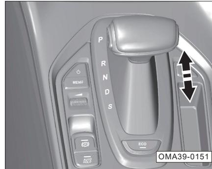
Las posiciones de la palanca de cambios son "P, R, N, D, S", cuando el interruptor de encendido está en la marcha "ON", después de que se engrane la marcha, la luz de marcha correspondiente en el panel de cambios se iluminará y el instrumento combinado mostrará la posición correspondiente. .
