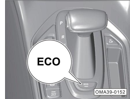
Cuando el interruptor de encendido está en la posición "ON", presione el botón ECO para ingresar al modo "ECO".
