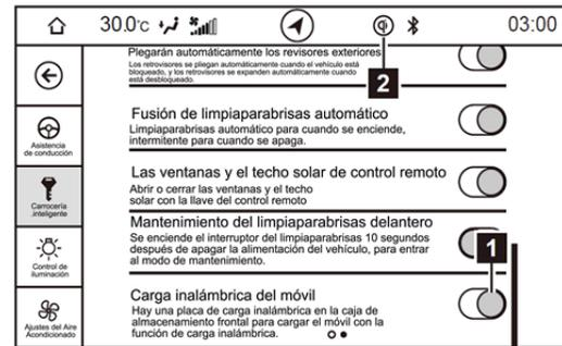
Quando el interruptor de ignición está en la posición "ON", ingrese la "Configuración del vehículo → Carrocería inteligente → Carga inalámbrica móvil" del sistema de sonido:
