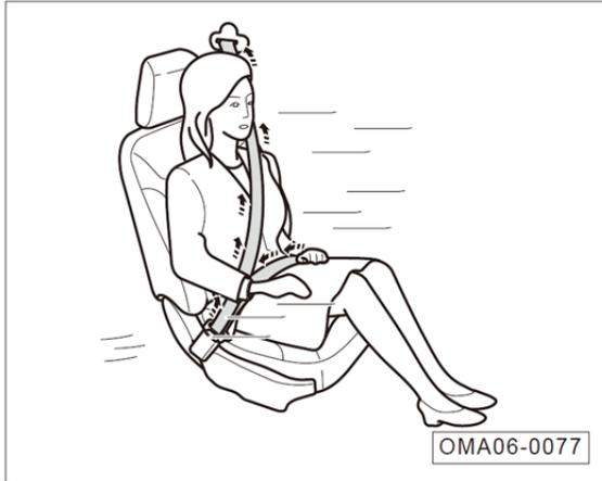
Los limitadores de esfuerzo y pretensores de los cinturones de seguridad pueden reducir la fuerza ejercida del cinturón de seguridad sobre el pecho del conductor y ocupantes, mejorando el rendimiento de protección.
