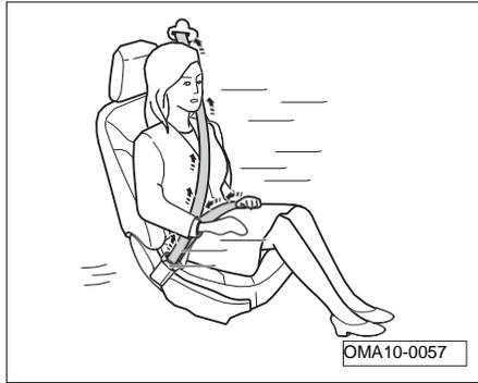
Los limitadores de esfuerzo y pretensores de los cinturones de seguridad pueden reducir la fuerza ejercida del cinturón de seguridad sobre el pecho del conductor y ocupantes, mejorando el rendimiento de protección.
