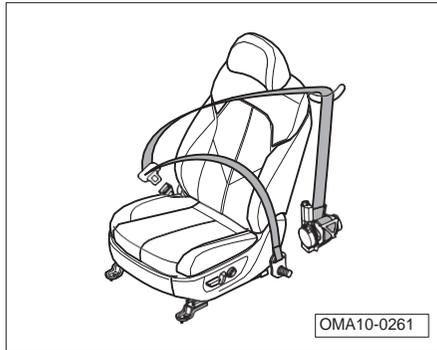
Al ocurrir colisión, llevar correctamente el cinturón de seguridad que puede sujetar los pasajeros en el vehículo en una posición adecuada, mitigando la inercia del movimiento hacia delante, evitando movimiento incontrolado de pasajero/conductor y ser expulsado, al mismo tiempo, les ofrece la mejor protección de bolsa de aire, reduciendo posiblemente por lo máximo los daños del impacto.
