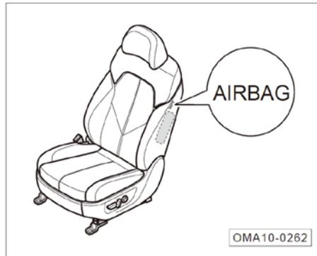
Se instala los airbags delanteros laterales dentro del lado interior del asiento de conductor y del respaldo de la de pasajeros delanteros (sombra en línea falsa), y el "AIRBAG" indicado por flecha es su signo.
