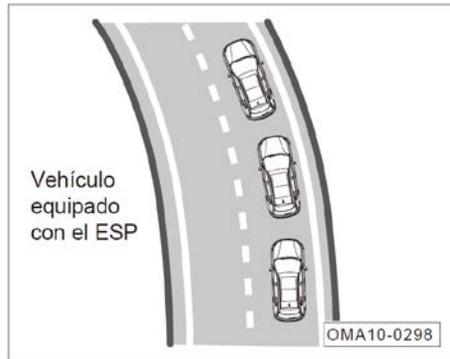
Mientras conduce, el vehículo que dispone del ESP puede corregir la fuerza de frenado de acuerdo con el desplazamiento, evitando la desviación de la ruta.
