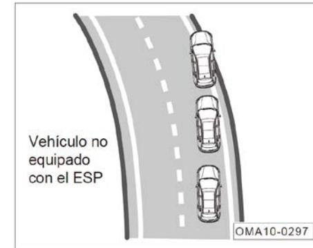
Los vehículos que no están equipados con ESP se deslizarán fuera de la línea de conducción normal al producir desplazamiento.
